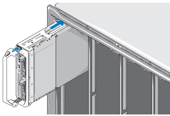
Deslize os módulos da caixa da esquerda para a direita, começando da parte superior. Quando a lâmina estiver instalada com segurança, a alça retorna para a posição fechada.
