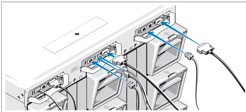
Conecte el cable serie y los cables de red del sistema de administración al módulo CMC. Si va a instalar un segundo módulo CMC opcional, conéctelo también.
