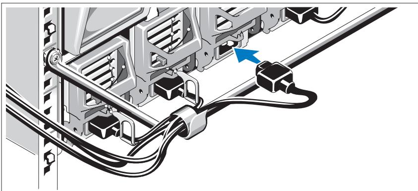
Conecte los cables de alimentación del sistema a las fuentes de alimentación.
