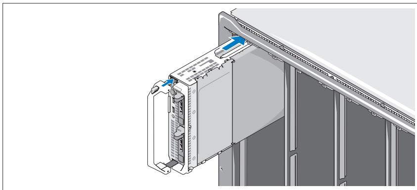
Insérez les modules dans le boîtier en commençant par le haut et en procédant de gauche à droite. Lorsqu'une lame est correctement installée, la poignée revient en position fermée.
