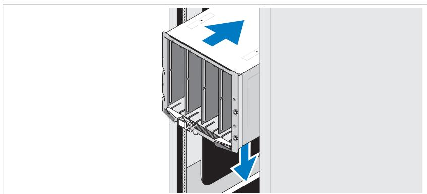
Monte los rieles e instale el sistema en el rack siguiendo las instrucciones de seguridad y de instalación del rack incluidas con el alojamiento.
