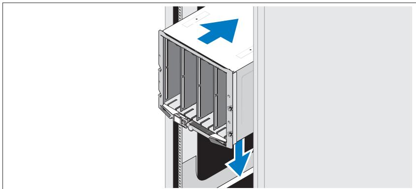
Assemblez les rails et installez le système dans le rack en suivant les consignes de sécurité et les instructions d'installation du rack fournies avec votre boîtier.
