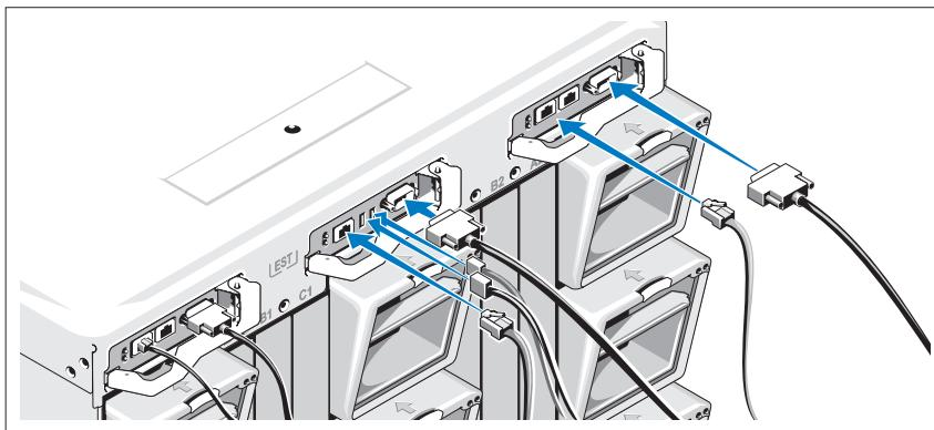
Connectez le câble série et le ou les câbles réseau du système de gestion au module CMC. Si un second module CMC en option est installé, connectez-le également.
